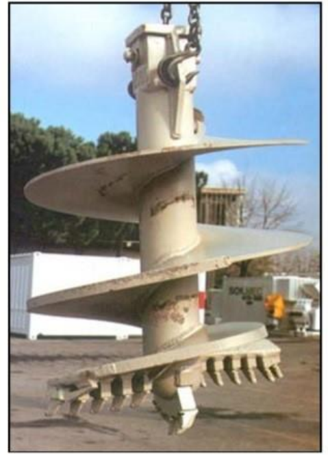
اگر (مته حلزونی) مورد استفاده در حفاری بسترهای سنگی سخت
