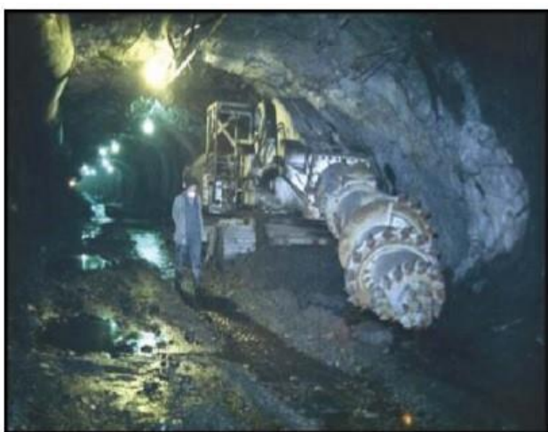
مورد TBM دستگاه حفاری تمام مکانیزه استفاده جهت حفاری در تونل
