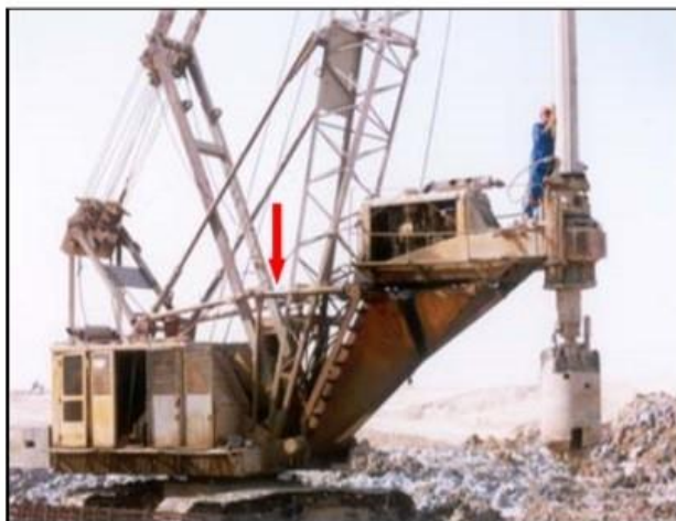
در این تصویر جک های اتصال ریگ به بدنه پررنگتر شده اند
